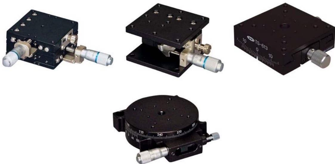
図 10 仕様したステージ (左上から XY ステージ, Z ステージ, 傾斜ステージ, 回転ステージ)
