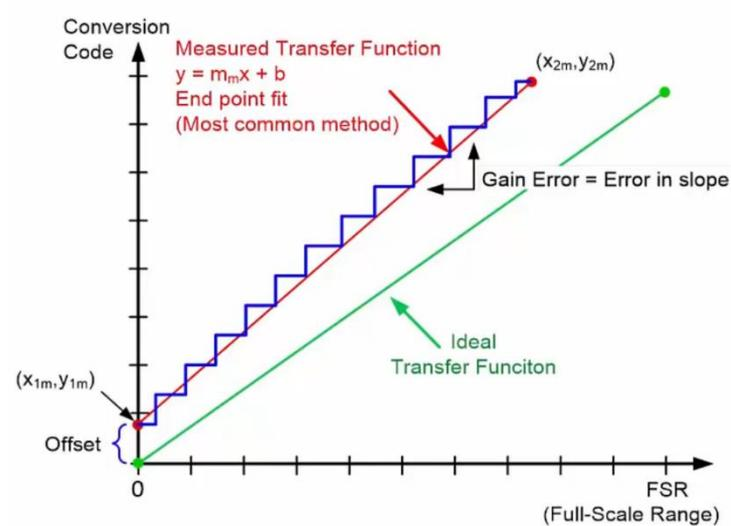
Fig. 2.16 Offset & Gain Error
