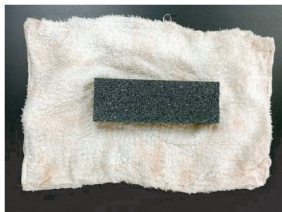
図3 砥石の使い方：濡らした雑巾の上に砥石を置いて研磨する
