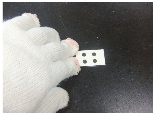
図6 熱したホットプレート上でのスライドガラスとスペーサーの貼り付け
