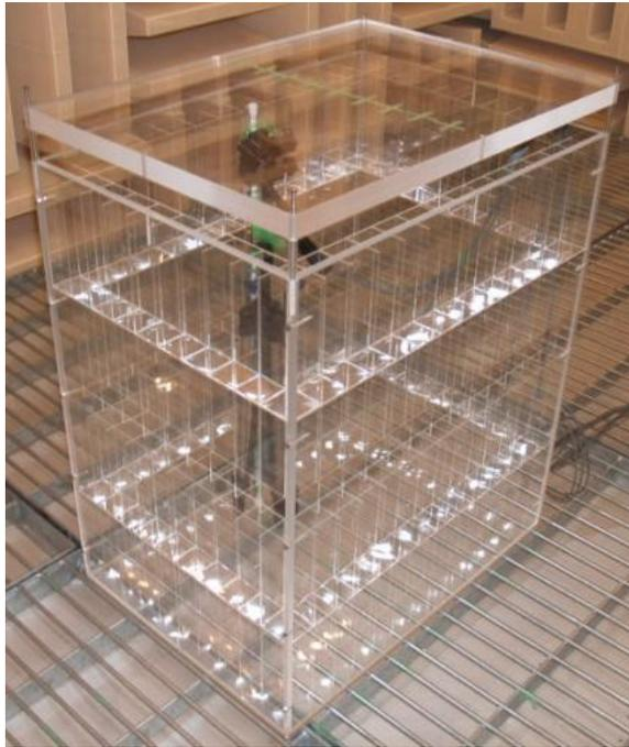
図 4-19 音響管搭載カバーの実験用試作物
