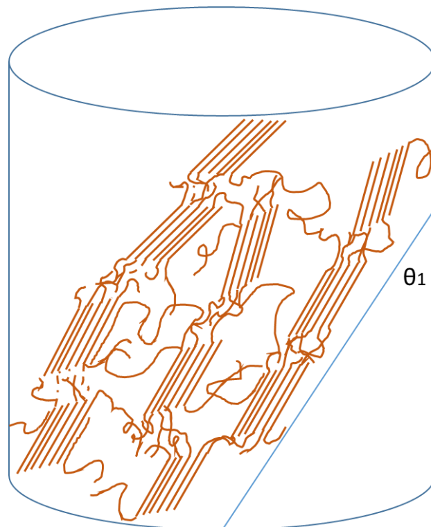
図 2-27 マーセル化されたケナフ繊維の構造模式図
