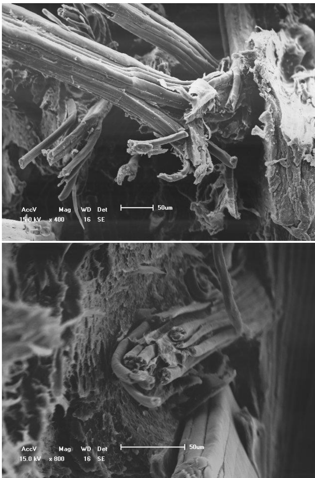
図 3-12 25wt% NaOH 処理 KF 強化 PS の破断面
