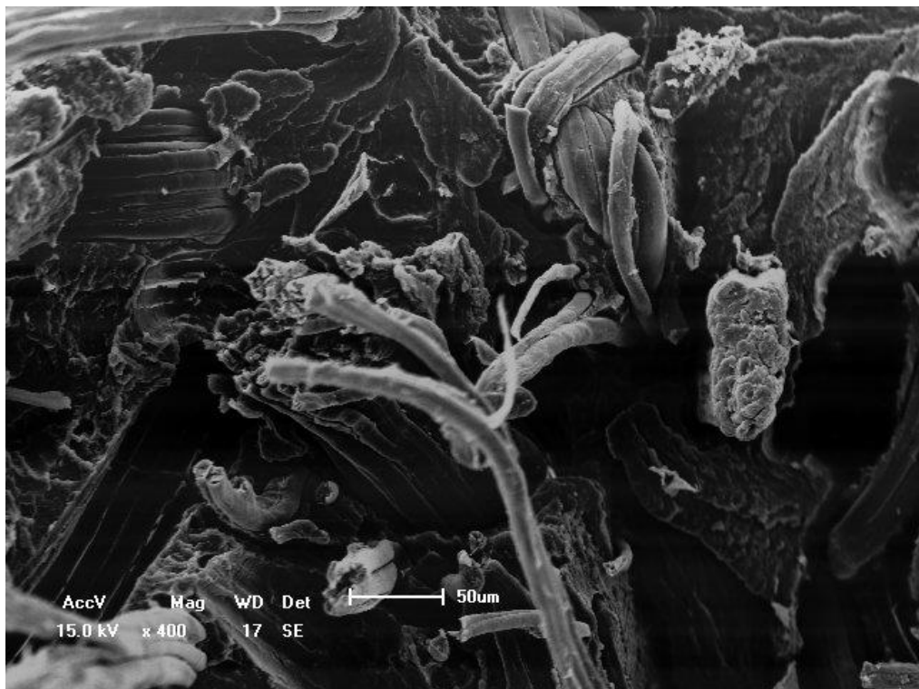
図 3-11 20wt% NaOH 処理 KF 強化 PS の破断面
