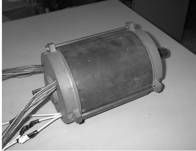
図 5-1 誘導電動機の外観
