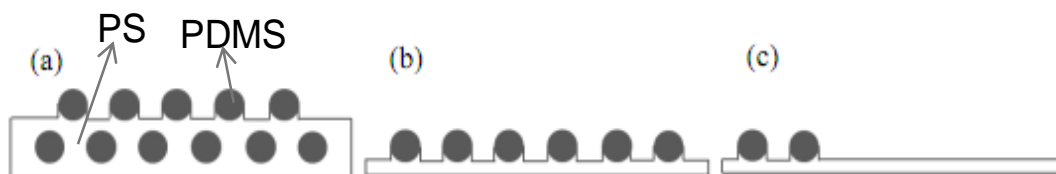
図 5.8 加熱する前の分子量 11,700-2,900 g/mol の PS-PDMS の薄膜の断面。
