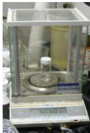
図 4.5 電子天秤による PGMEA 軽量測定
