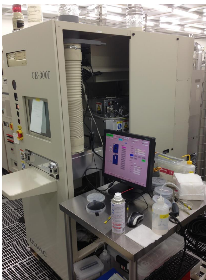
図 4.10 ICP 型 RIE の CE-300I エッチング装置の外観
