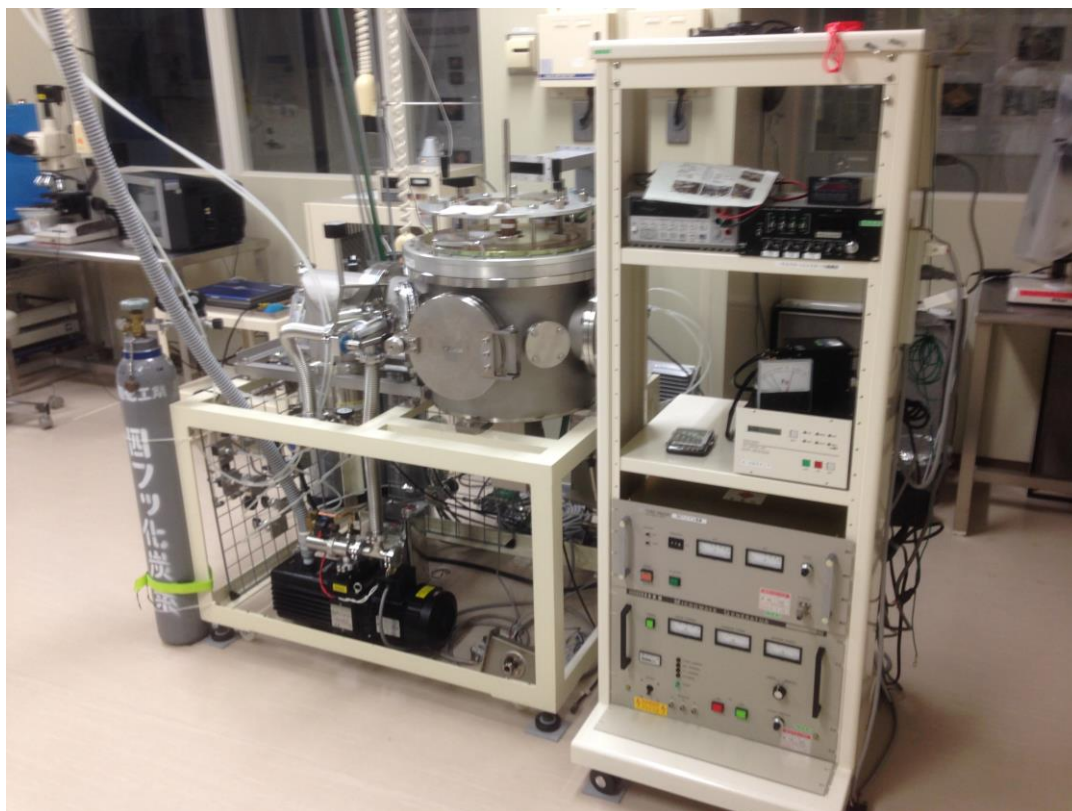
図 4.9 ECR 型エッチング装置の外観
