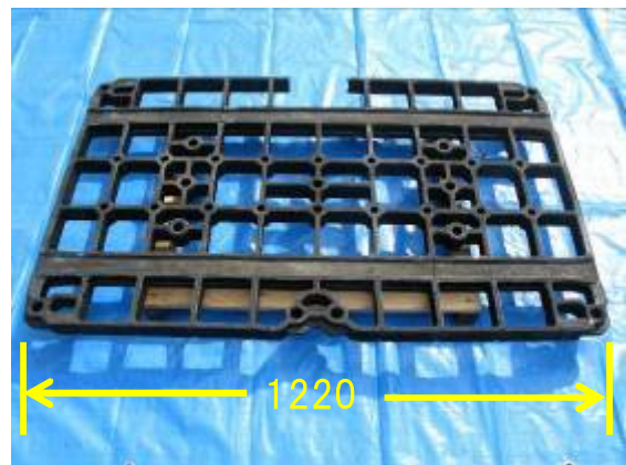
(b)破損により不能となったベーストレイ
