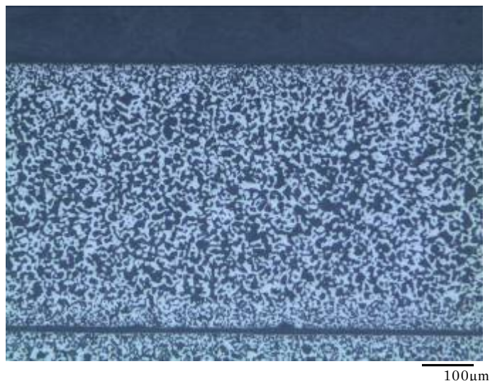
図 3.5 板厚 0.5 mm の光学顕微鏡組織 (腐食液：3%ナイトル)
