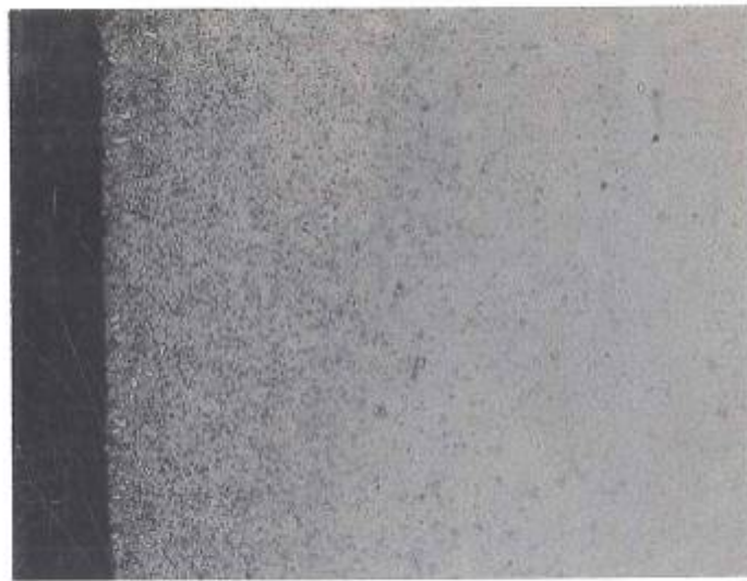
図 5.1 半球シューの光学顕微鏡組織（腐食液：3%ニッケル）
