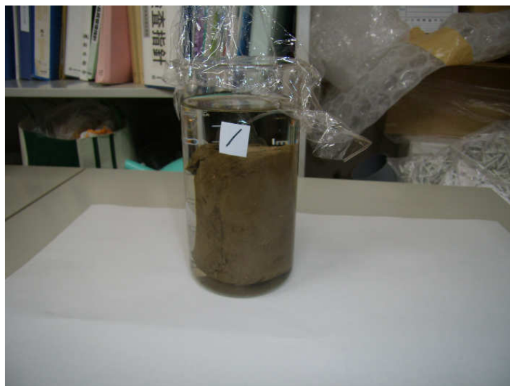
写真 2-6 施工現場の実態を想定して実施したフッ素の溶出試験
