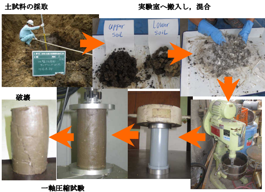
写真 2-4 土試料の採取から一軸圧縮試験を実施するまでのプロセス
