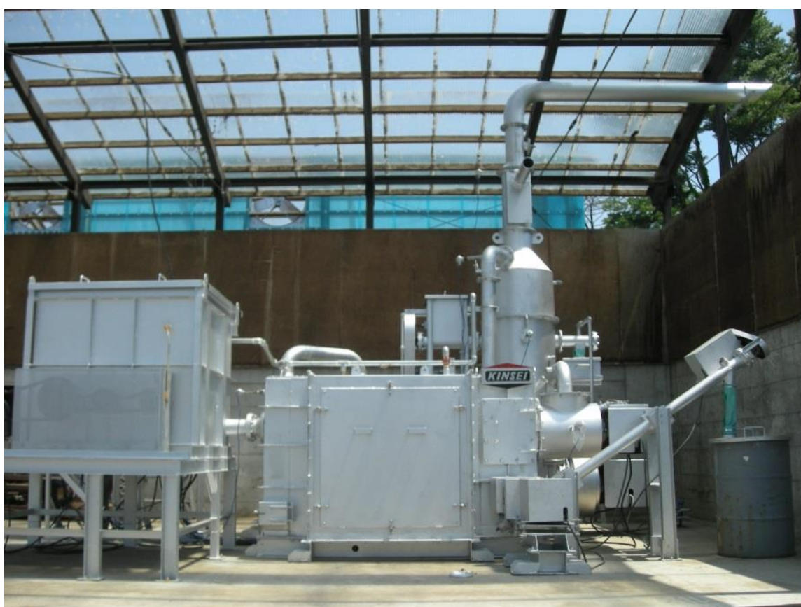
Fig. 3-3 日量1トン鶏糞灰化・炭化装置外観写真((株)キンセイ産業製)
