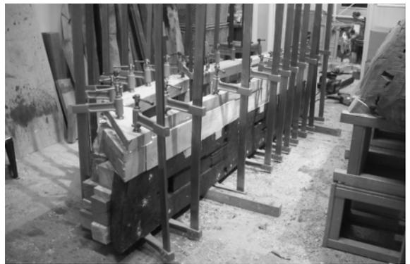
写真27 新たに 2 段目を圧着している
