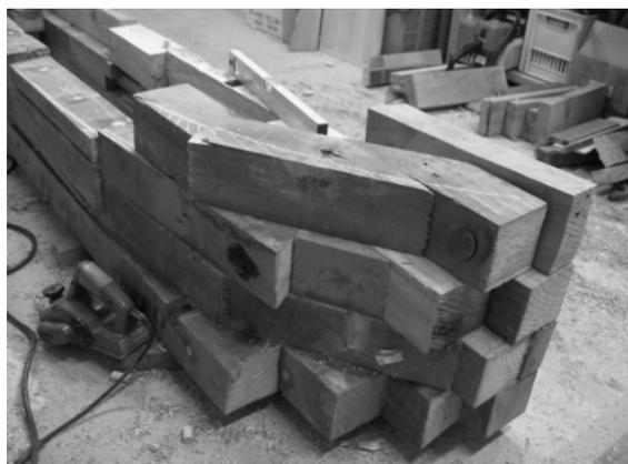
写真9 先端部分の切削前段階の造作
