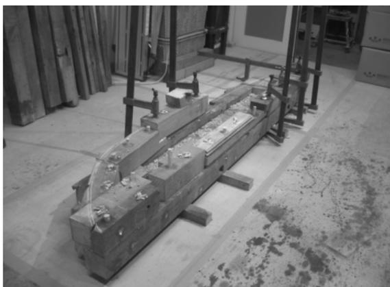
写真8 2段目接着中 上部に見える突起は補強の「ダボ」、圧着に使用している工具が「はたがね」
