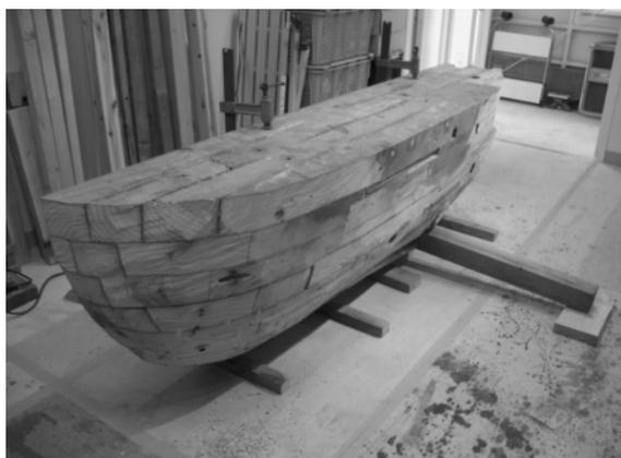
写真16 脚部を取り付けたところ 下部を貫通する形で入っている
