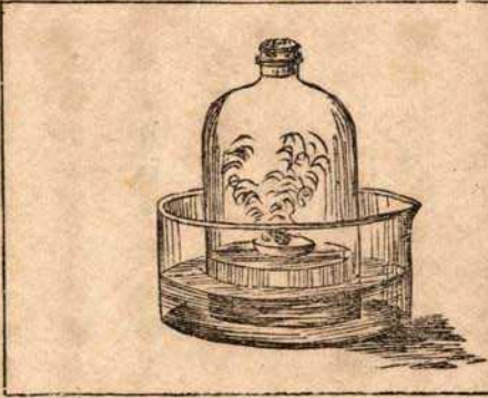
空氣中の窒素を測る試験
