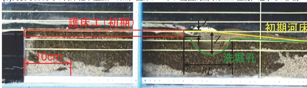
(b)実験 Case3-3 : 河床低下量 \Delta H=4\text{cm} , 護床ブロック配置間隔 0.5mm 程度, 通水 54 秒後
