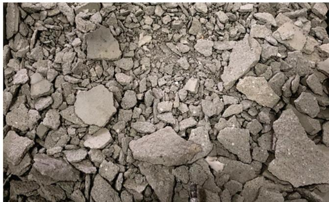
b) 加熱後の炉底から採取した剥落片
