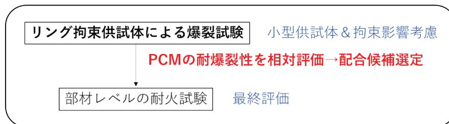
図 9-1 PCM の爆裂抑止設計手法のイメージ
